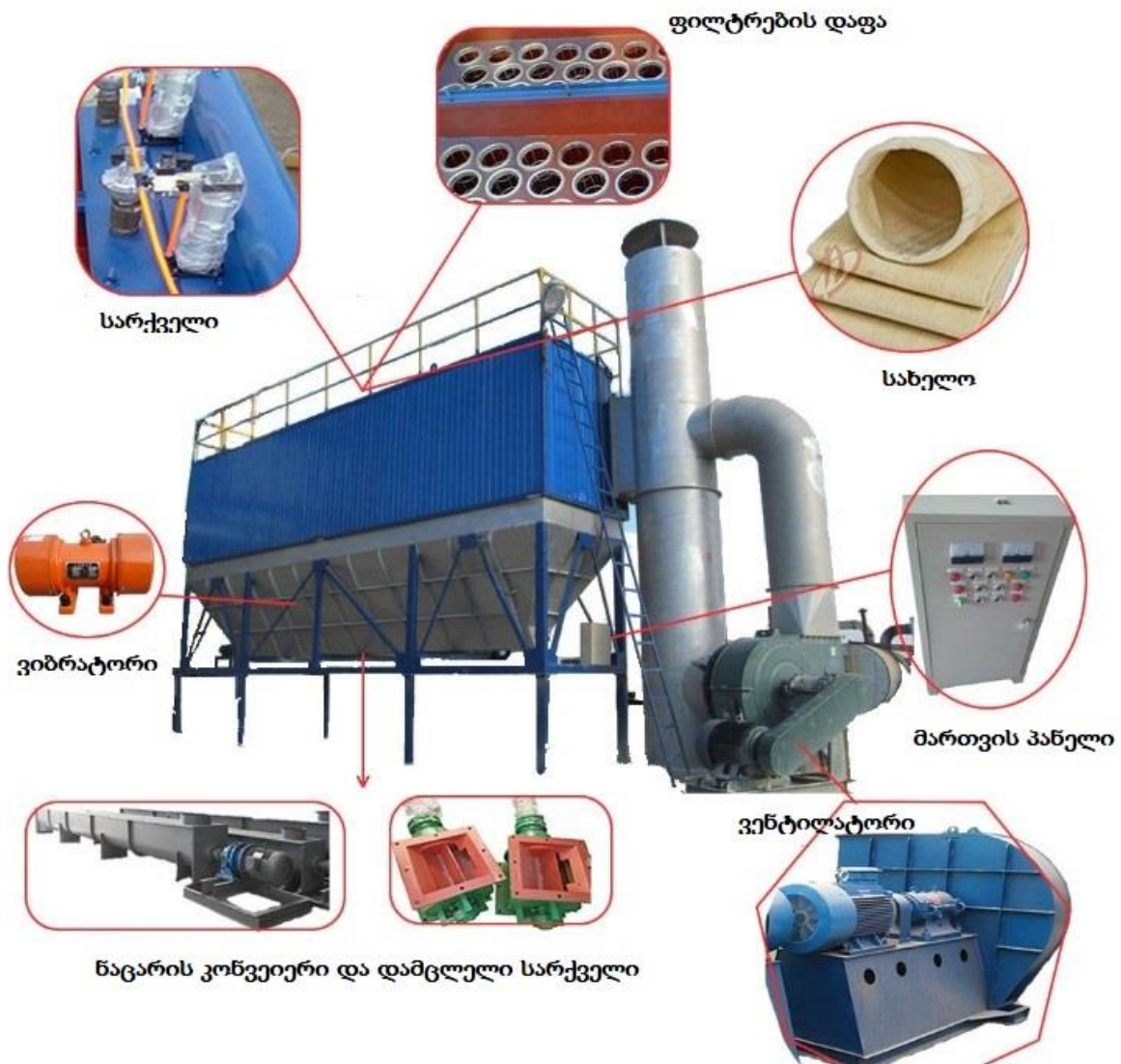
სურათი 4.2.1.1.2. აირმტვერდამჭერი სისტემის ტიპური ხედი და შემადგენელი კვანძები
