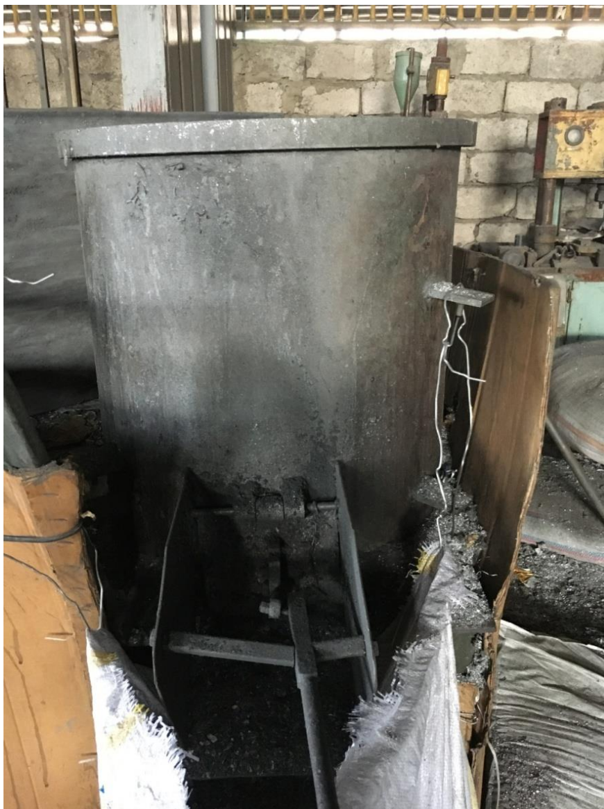
სურათი 4.2.3.1. ალუმინის ქილის დასაფქვავი დანადგარი (თვითნაკეთი)
