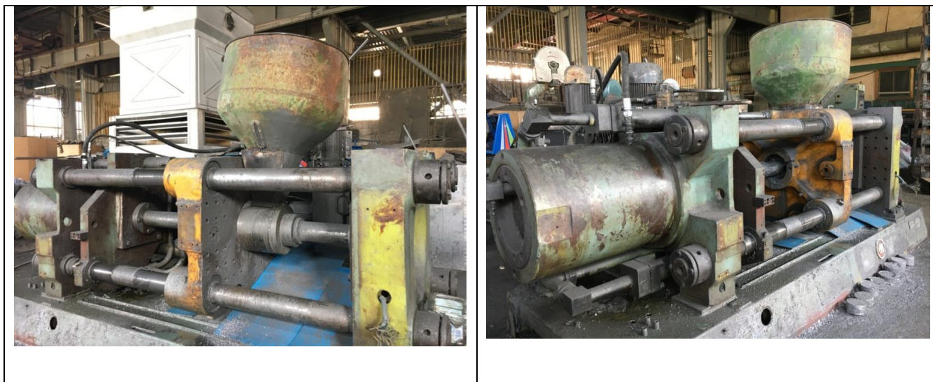
სურათი 4.2.3.2. დაქუცმაცებული ალუმინის დასაწნეხი დანადგარი (თვითნაკეთობა)
