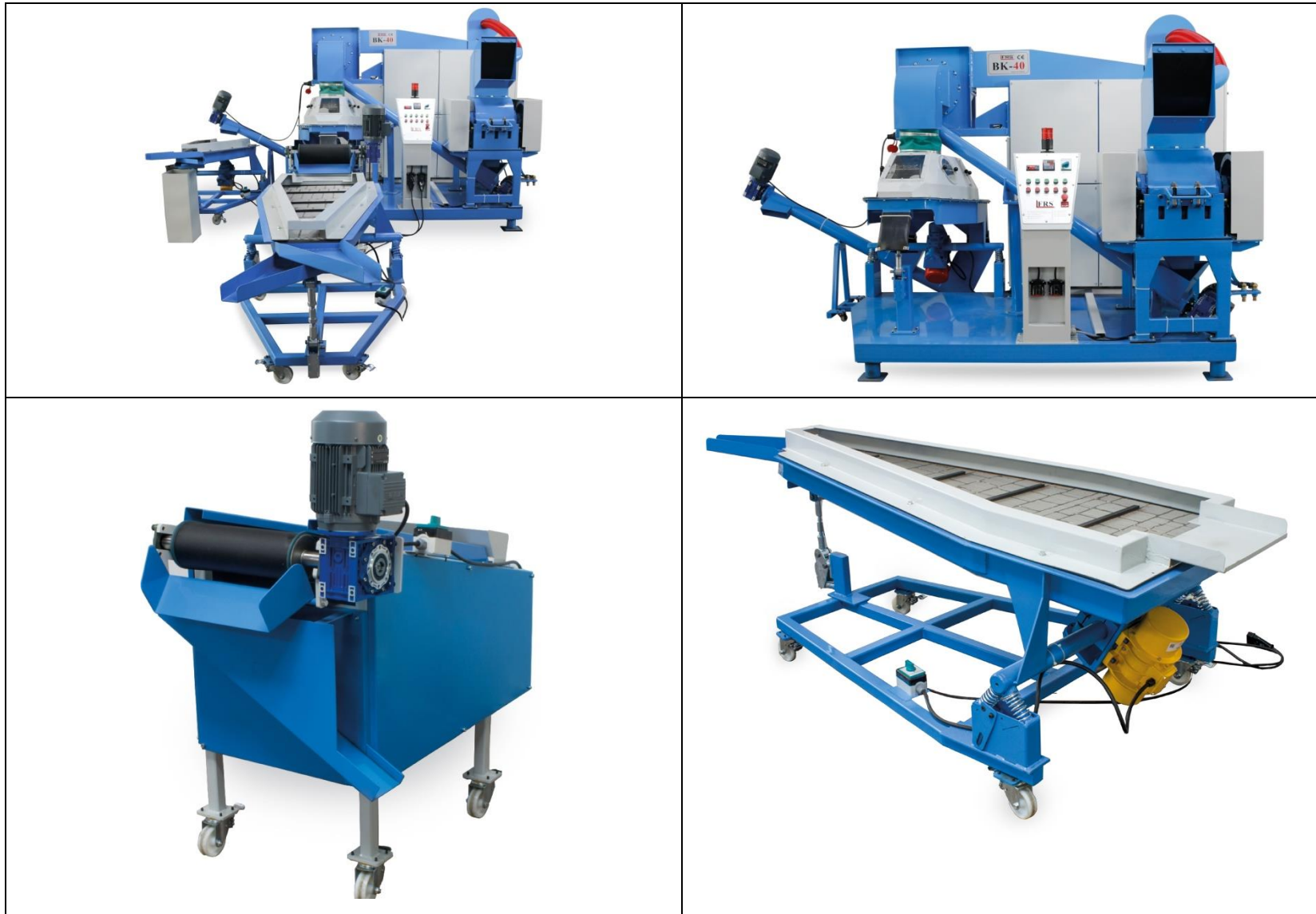
სურათი 4.2.8.6. ელექტრული სადენების გადასამუშავებელი BK40 FRS-BK40 მოდელის დანადგარი
