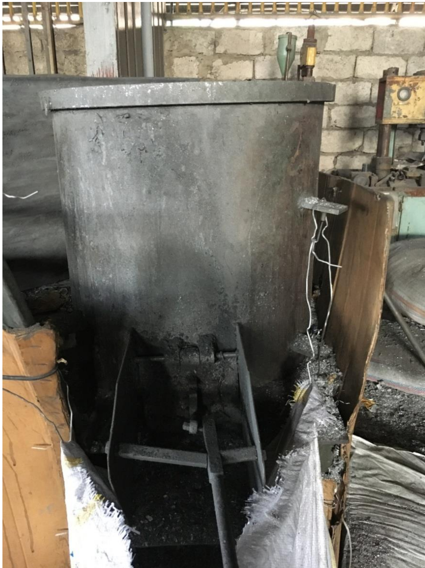
სურათი 4.2.3.1. ალუმინის ქილის დასაფქვავი დანადგარი (თვითნაკეთი)
