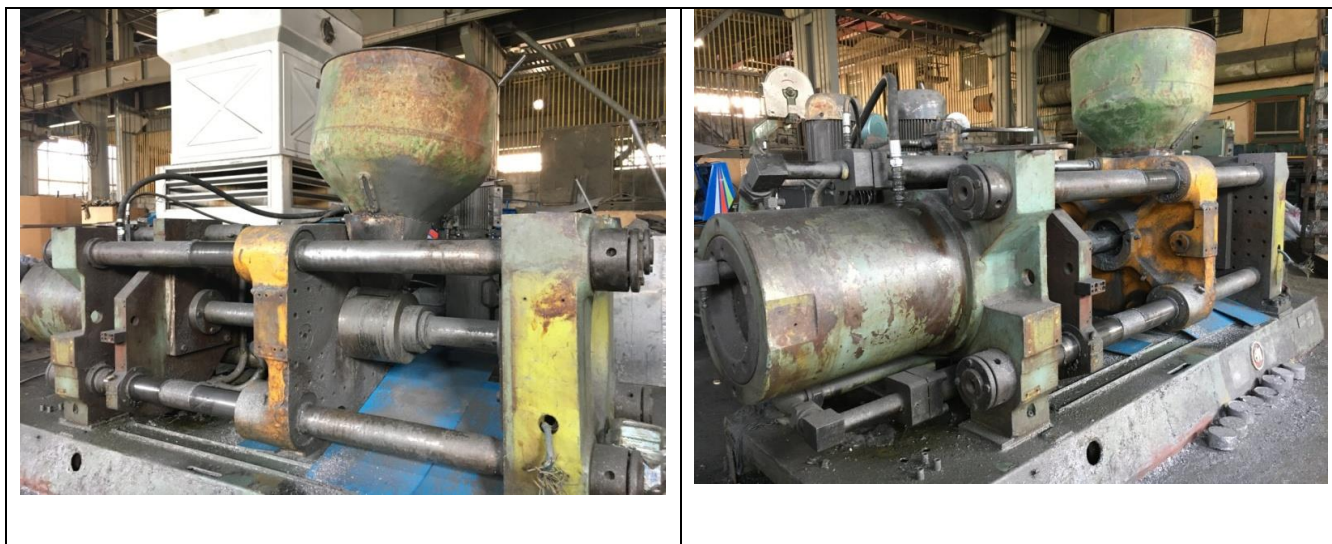
სურათი 4.2.3.2. დაქუცმაცებული ალუმინის დასაწნეხი დანადგარი (თვითნაკეთობა)
