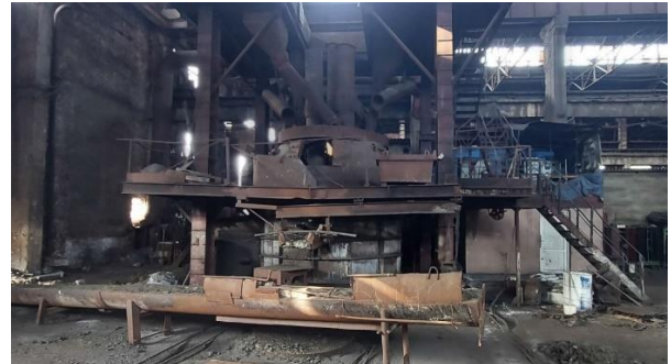
დაკონსერვებული მადანაღმდგენელი 5 მგვტ-იანი სილიკომანგანუმის ღუმელი
