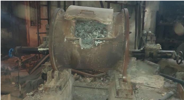
დაკონსერვებული ერთ ტონიანი ჰორიზონტალური ელექტრორკალური ღუმელი
