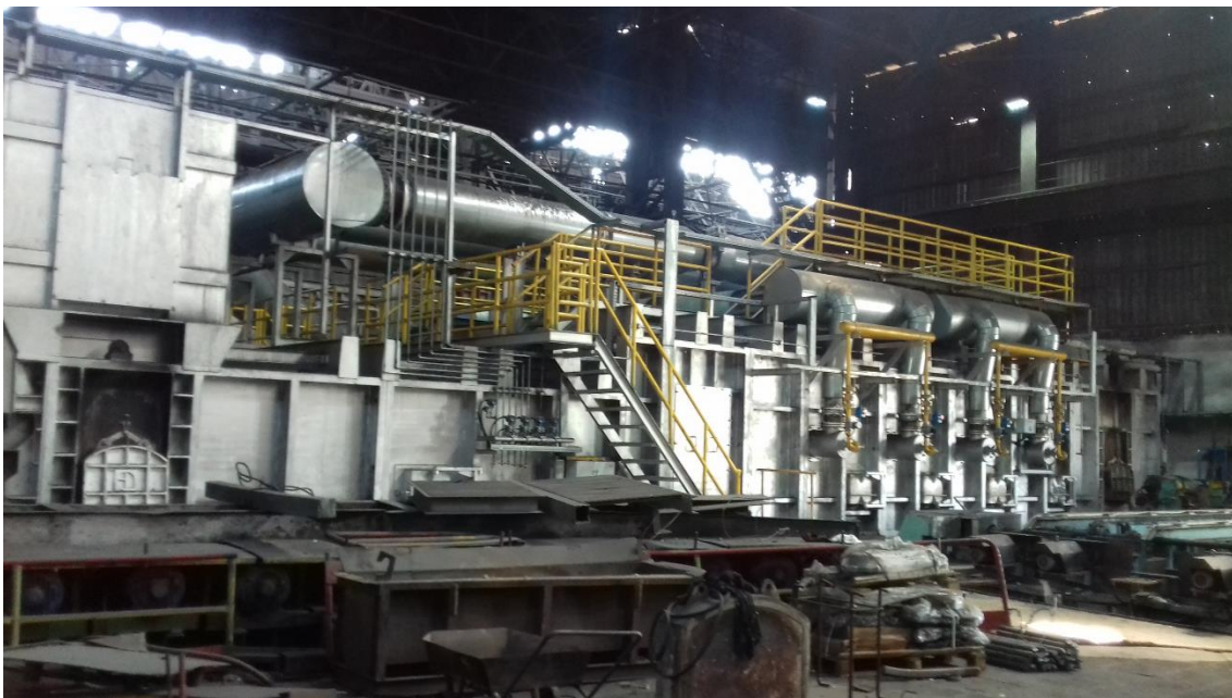
სურათი 4.3.4.1. სორტული გლინვის საამქროს მოქმედი 43/ტ/სთ წარმადობის ღუმელი
